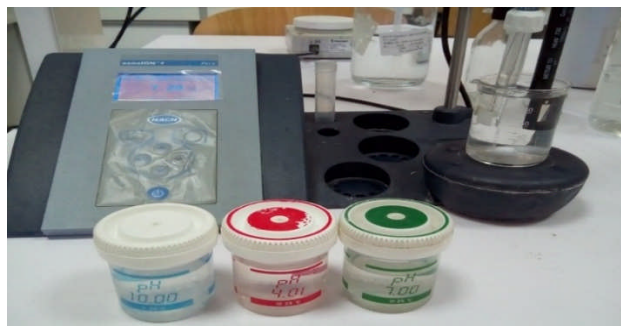
Figure N° 13 : Solutions de l'étalonnage (SEAAL El-Harrach).
