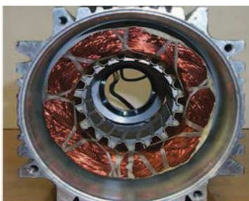
Figure.14: le stator de l'MSAP
