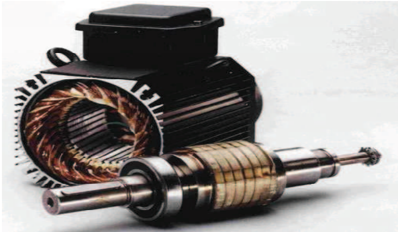
Figure I.13 : Le moteur synchrone à aimants permanents
