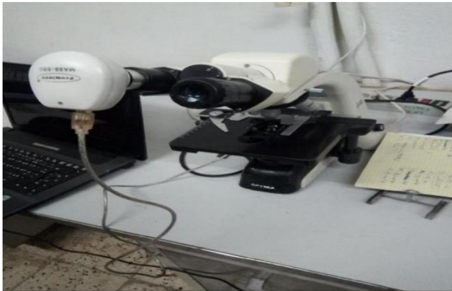
Figure 15: Dispositif de prise d'image (caméra, microscope et ordinateur)
