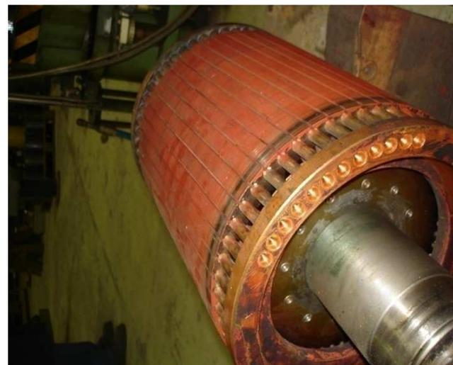
**Figure 9.** Forme des barres de la cage externe.
