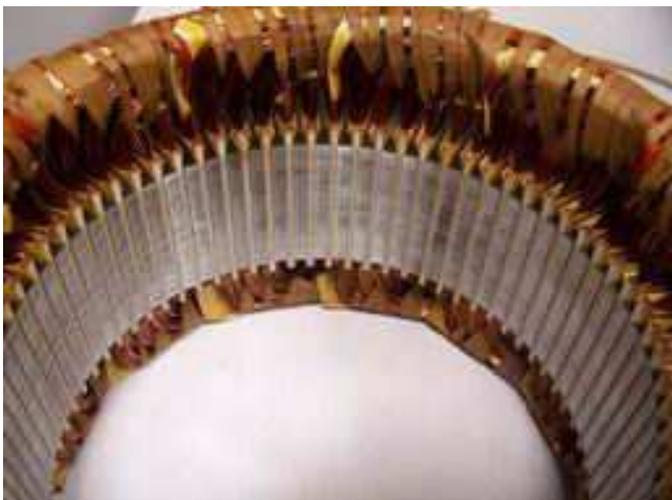
**Figure .1.Stator avec bobinage**
