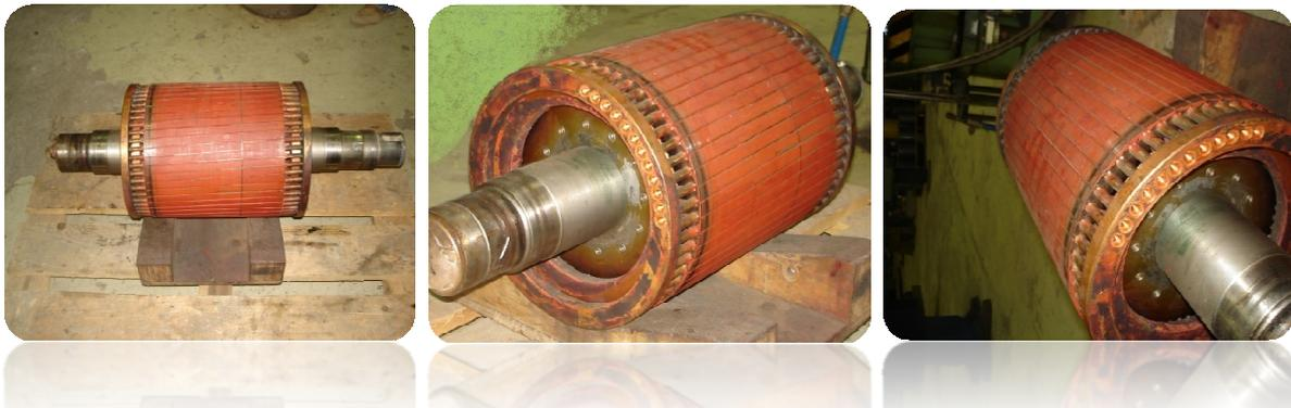
**Figure 6. Rotor à double cages**
