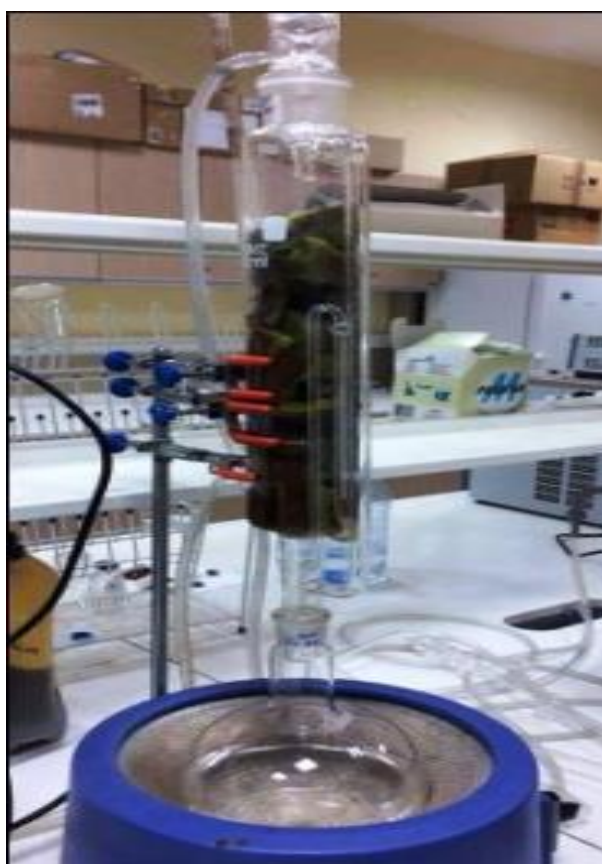
Figure II.2: Montage de l'extraction au Soxhlet.
