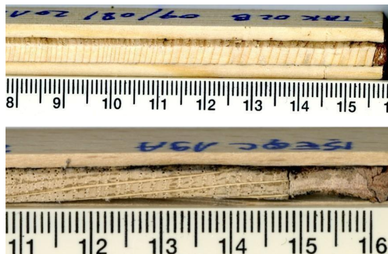
Figure 2.5. Carottes poncées après montage sur des supports en bois rainurés : en haut, carotte du cèdre de l'Atlas, caractéristique des résineux, avec un cerne dont la limite est déterminée par un bois d'été sombre ; en bas, carotte du chêne zéen, caractéristique des feuillus caducifoliés avec un bois à zones poreuses (gros vaisseaux conducteurs du bois de printemps) suivies de zones compactes (bois d'été) (photo : S. Slimani).
