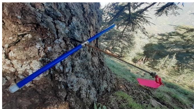
Figure 2.4. Carottage d'un cèdre de l'Atlas à TAK (photo : S. Slimani).
