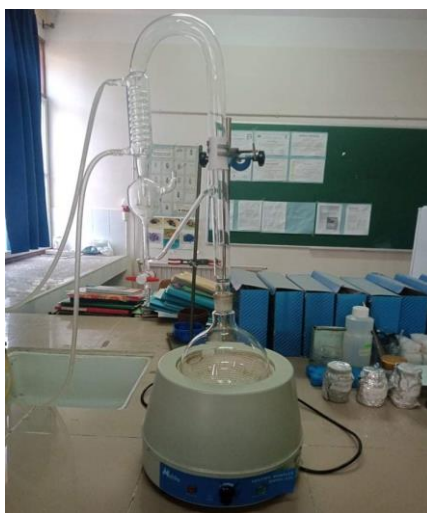
Figure 16: Montage d'hydrodistillation manipulé (Clevenger) (Laboratoire d'entomologie, 2021).
