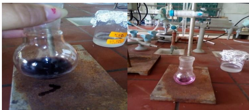
Figure 21: Titrage de l'excès de KOH par du HCL (Laboratoire de cinétique,2021)
