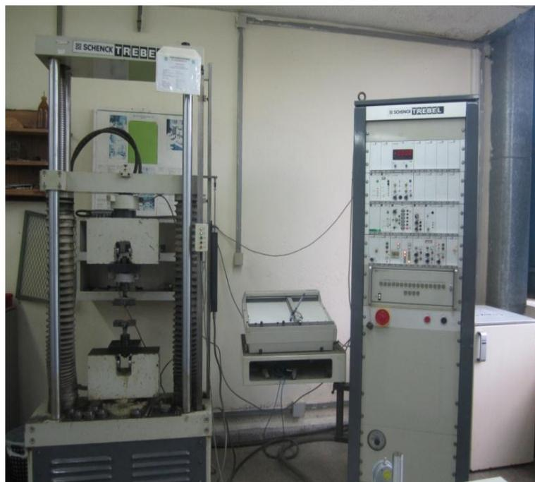
Figure IV.8 : Machine de traction.
