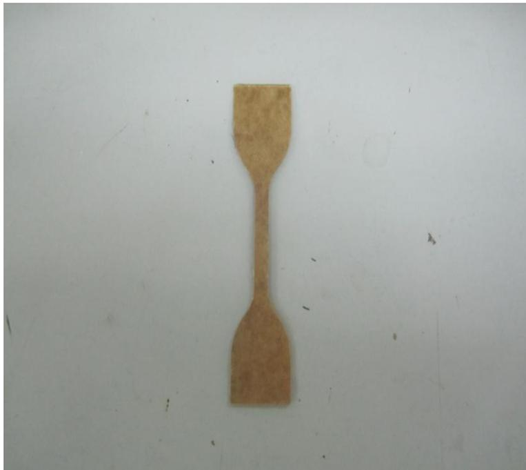
Figure IV.4 : Eprouvette sous forme d'haltère utilisée pour les essais de traction.
