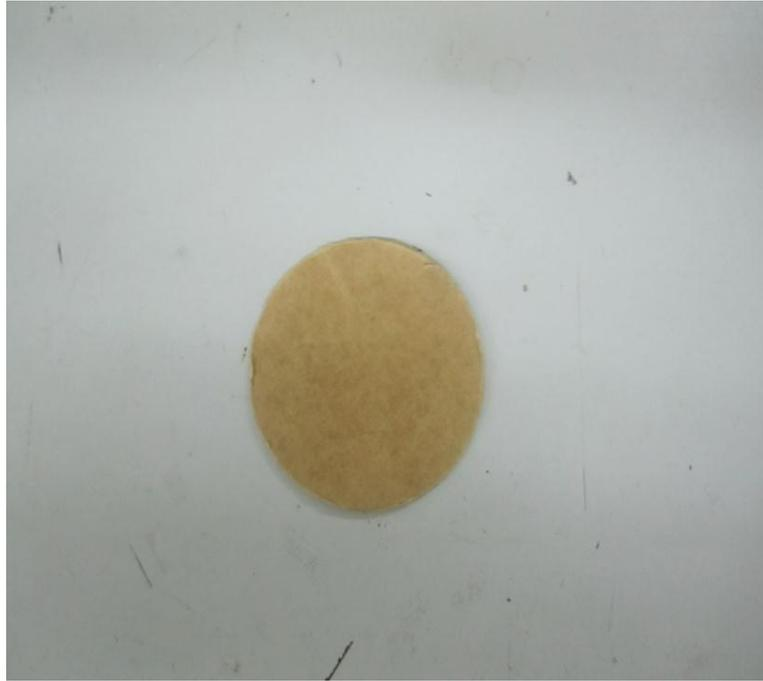
Figure IV.3 : Eprouvette de forme circulaire pour les tests de mesure du facteur de pertes diélectriques, de la permittivité et de la résistance 'isolement.
