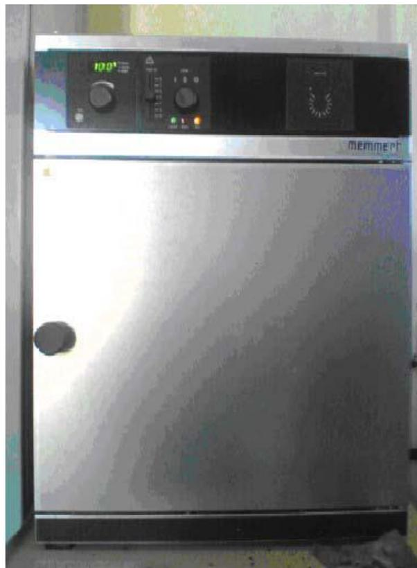
Figure IV.1 : Etuve de vieillissement.
