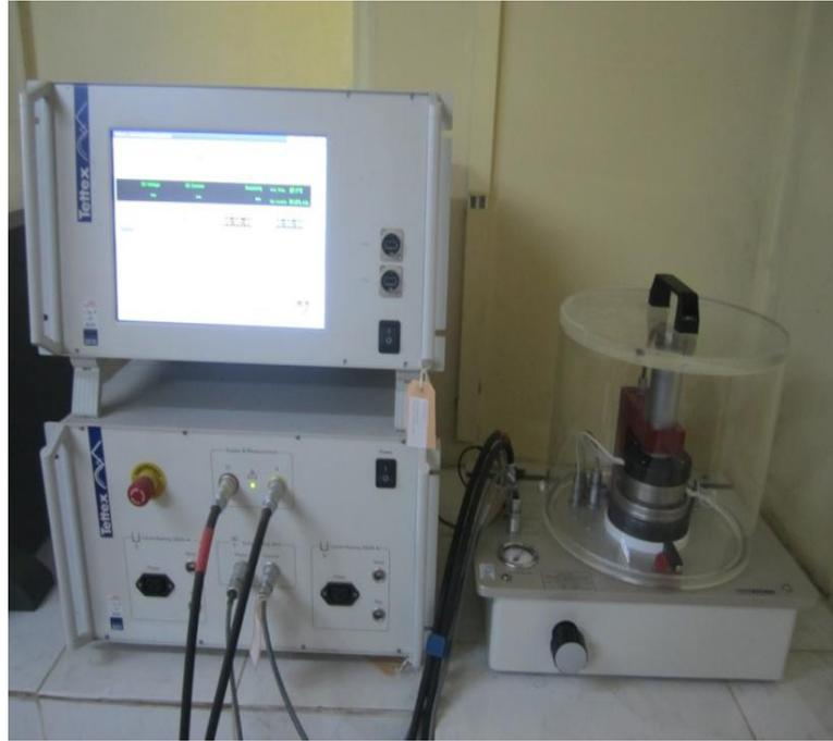
Figure IV.7 : Pont de Schering.
