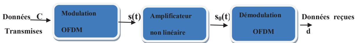
Figure III.9. Modèle utilisé pour le calcul de l'expression de la non-linéarité dans le domaine fréquentiel [16]
