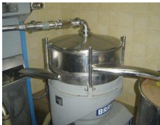
Figure 11 : Centrifugeuse à droite sortie de l'huile d'olive, à gauche sortie des margines (Veillet, 2010)
