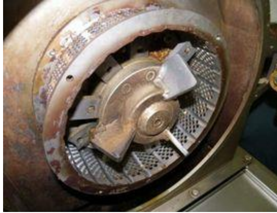
Figure 10 : Broyeurs à marteaux (Veillet, 2010)
