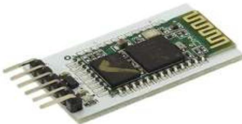
Figure III.2 : Vue du Module Bluetooth HC-05
