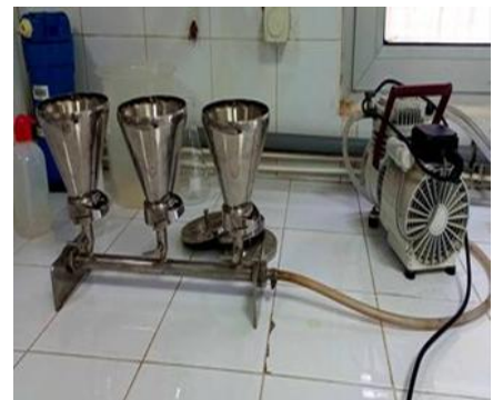
Photo 6 : Rampe de filtration
