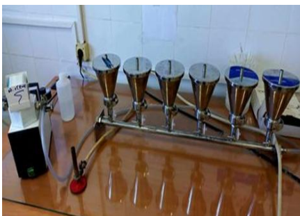
Photo 7 : Rampe de filtration et pompe à
