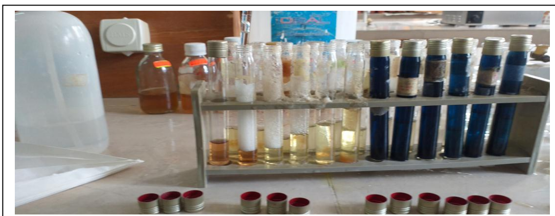
Figure 15 : Effervescence et coloration bleue après l'ajout de réactif chloro-molybdique
