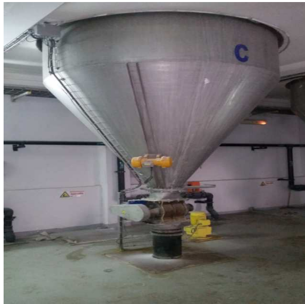
Figure II.2 Modèle d'installation préparateur d'hypochlorite de calcium
