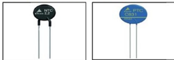
Figure (II-7) : Photos des deux types de thermistance CTN et CTP
