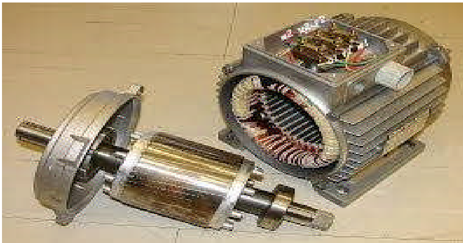
Figure (I-3) : Les deux parties essentielles de la machine asynchrone
