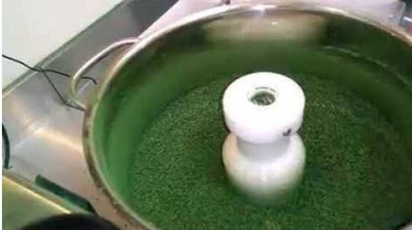
Figure 19 : Le broyage de la spiruline séchée.
