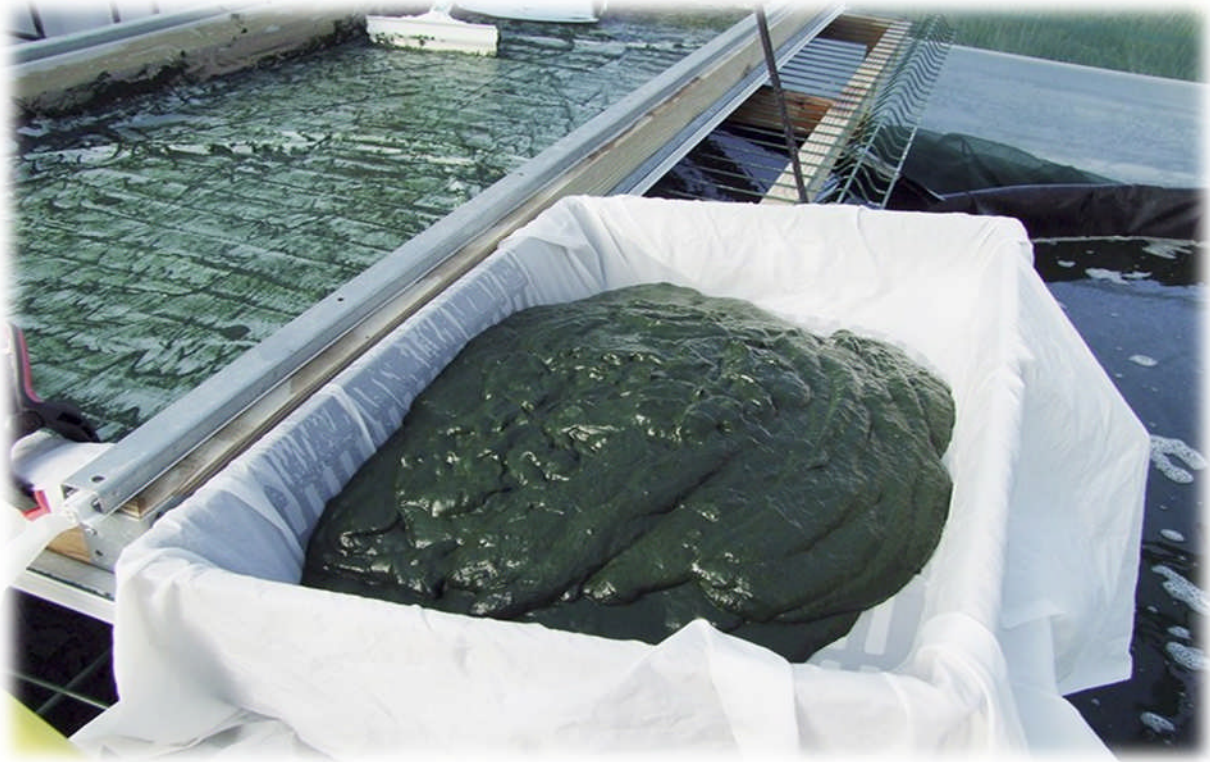
Figure 16 : Filtration de la spiruline.
