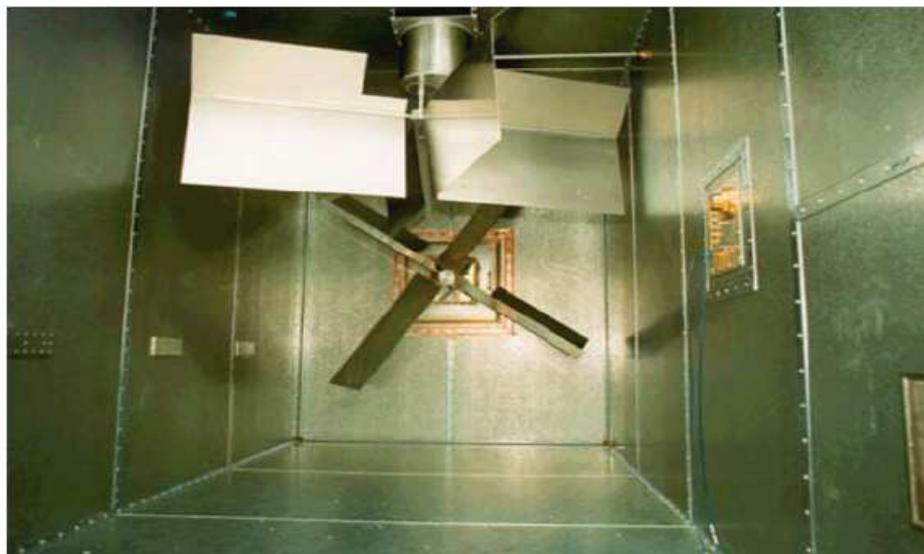
**Figure III-4 :** Exemple de chambre réverbérante
