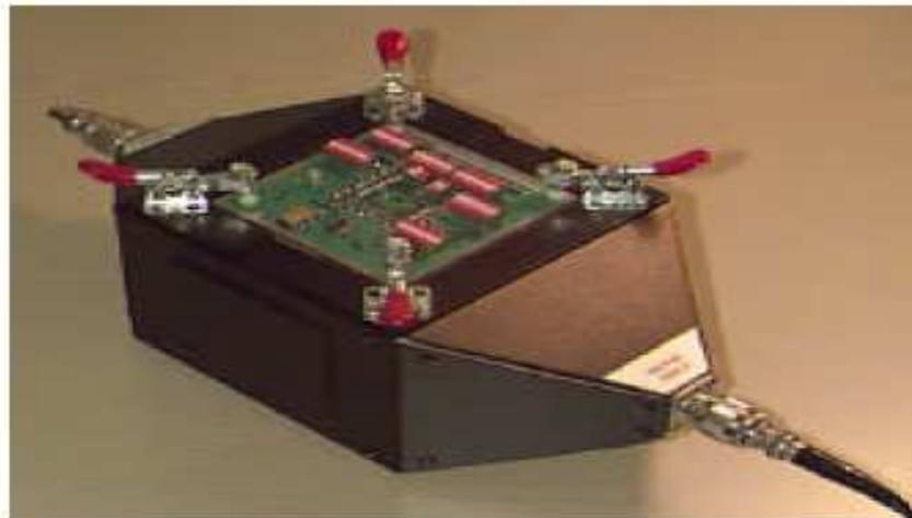
**Figure II-1:** Cellule TEM utilisé pour mesurer les perturbations électromagnétiques rayonnées par le circuit intégré
