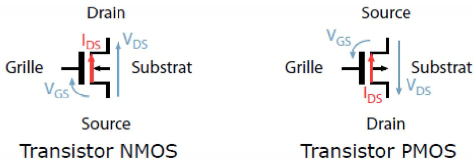
Figure I-2: Symbole électrique d'un transistor NMOS et PMOS
