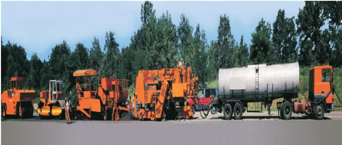
**Figure 3.5 Atelier de retraitement en place à froid[25]**
