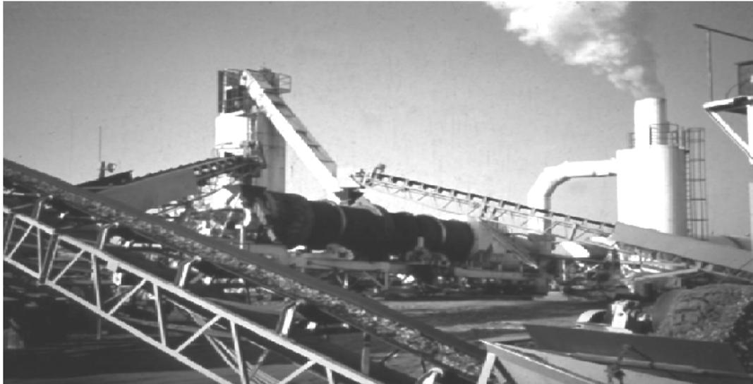
**Figure 3-1 : Poste d'enrobage type à fournée, à débits parallèles. .[39]**
