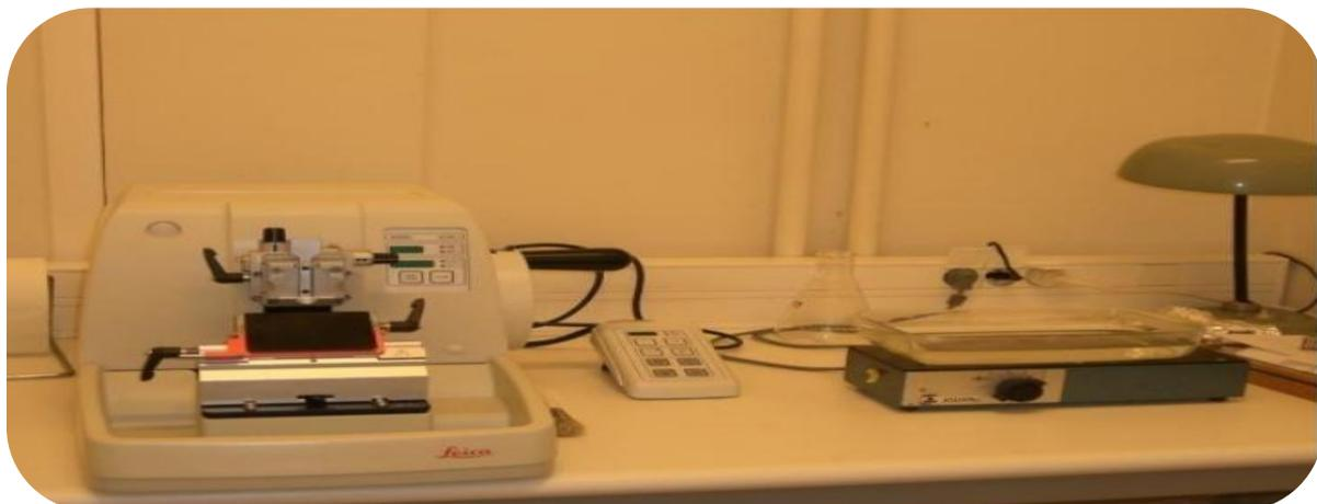
**Figure 26 :** Dispositif permettant de faire des coupes : microtome à gauche et bain Marie à droite (Originale, 2019).
