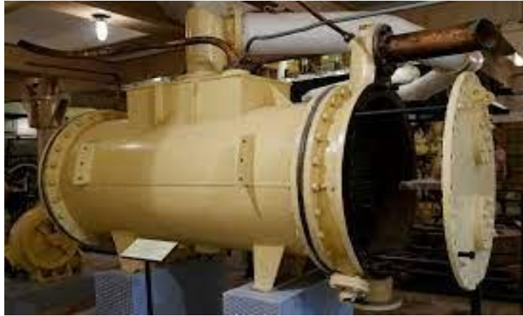
Figure I.3 : Vue réelle d'un condensateur par surface.
