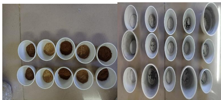
Figure 2. Avant l'incinération et après des différents échantillons (original, 2025).
