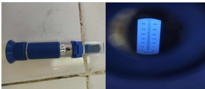
Figure 5. Réfractomètre pour mesurer le degré Brix (original, 2025).
