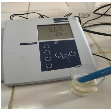
Figure 3. Mesure de PH a` l'aide d'un pH-mètre (Original, 2025).
