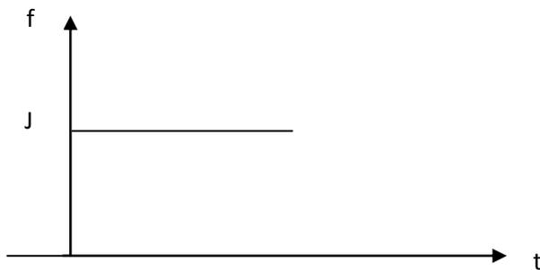
Figure(III.6).La fonction de fluage d'un solide élastique parfait
