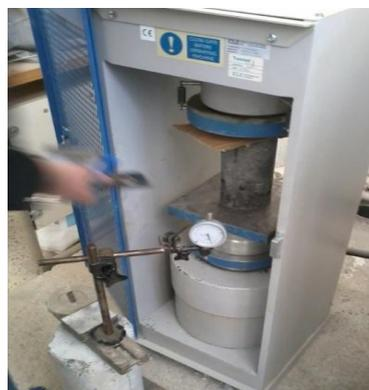
**Figure(V.15) : Machine de compression.**
