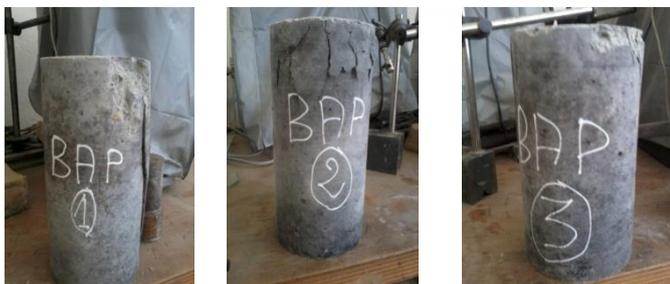
Figure (V.26) : Les éprouvettes cylindriques après déformation.
