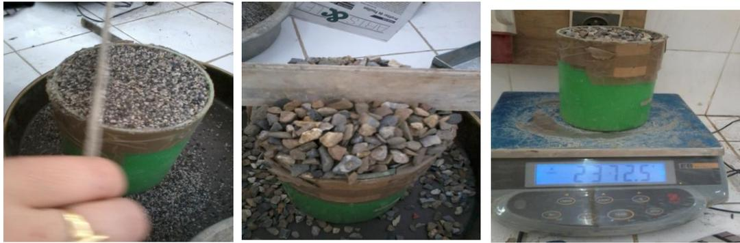
Figure : Méthode de mesure de la masse apparente
