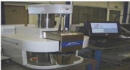
**Figure(III.1) : Rhéomètre capillaire à écoulement forcé**
