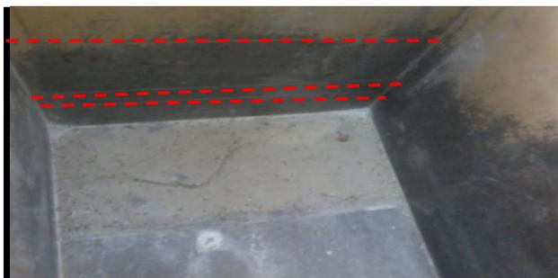
Figure(V.5) : Les trois traits (niveau) de Maniabilimètre.
