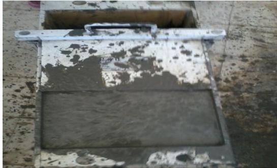
**Figure(V.17) : Mise de béton dans le Maniabilimètre.**
