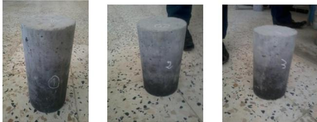
**Figure(V.22) :** Les éprouvettes cylindriques de BO avant écrasement
