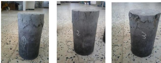
**Figure(V.23) :** Les éprouvettes cylindriques du BO après écrasement.
