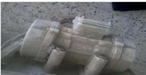
Figure : Vibrateur de maniabilimètre
