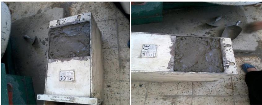
Figure(V.9) : Remplit le Maniabilimetre du béton.
