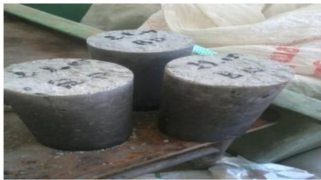
**Figure(V.13) : Décoffrage des éprouvettes.**
