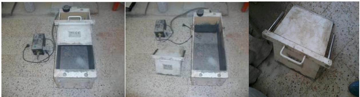
Figure(V.I) : Le Maniabilimètre de LCPC (disponible dans notre laboratoire)
