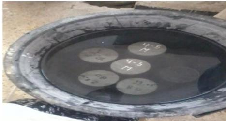
**Figure(V.14) : Mettre les éprouvettes dans l'eau.**
