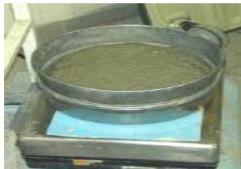
Figure (I.16) - Essai de stabilité au tamis
