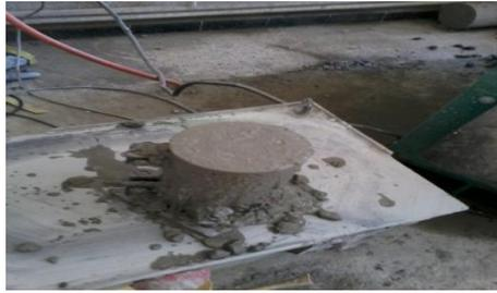
**Figure(V.12) : Vibration des éprouvettes.**
