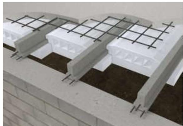
**FIGURE I.3. Corps creux en polystyrène.**
