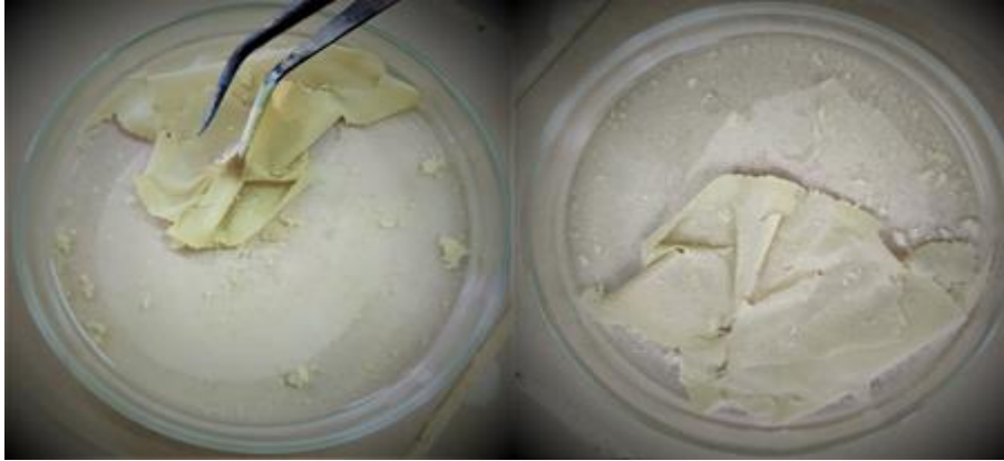
Figure 22. Emballage obtenu après polymérisation du mélange (Polysaccharide extrait de mucilage et glycérol).
