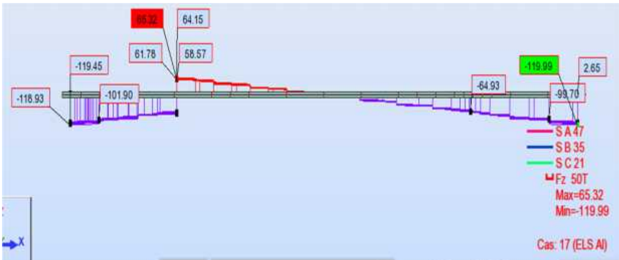
Figure VI.23 : diagramme de l'effort tranchant sous la combinaison la plus défavorable à l'ELS
