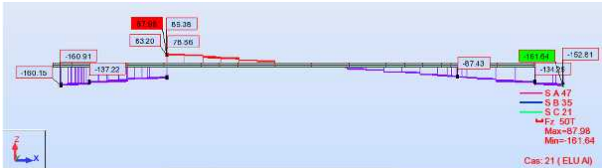
Figure VI.22 : diagramme de l'effort tranchant sous la combinaison la plus défavorable à l'ELU.
