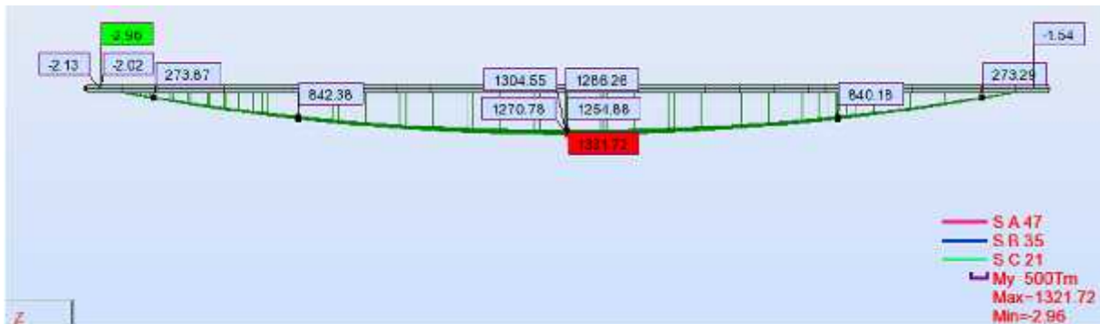
Figure VI.24 : Diagramme du moment fléchissant max sous la poutre la plus sollicitée.
