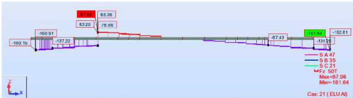
Figure VI.25 : Diagramme de L'effort tranchant Max sous la poutre la plus sollicitée.
