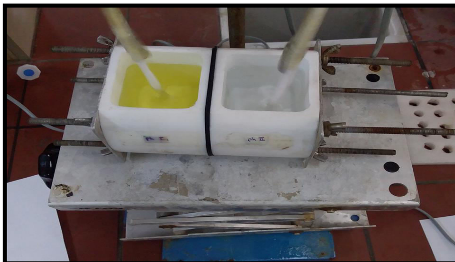
Figure III.5 : Schéma d'une cellule de transport de téflon.
