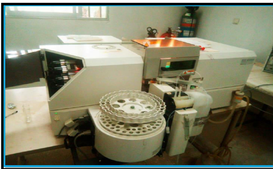
Figure III.6. :Spectrophotomètre d'absorption atomique à flamme (SAA) Shimadzu 6800.
