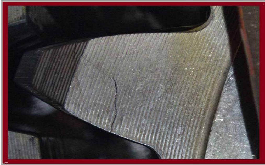
**Figure II .7 :** Défaillance d'une dent planétaire de la boîte de vitesse [42]
