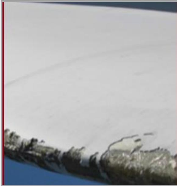
**Figure II .8** : érosion d'une pale [42]
