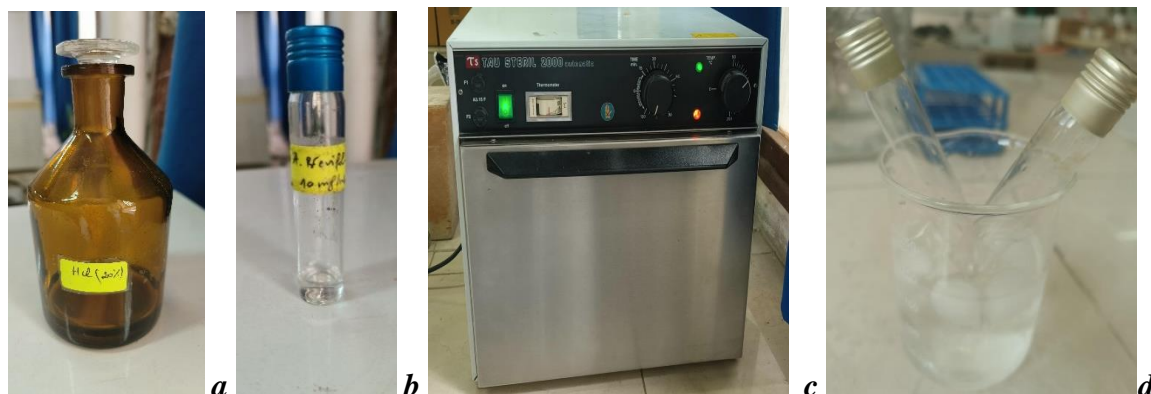
Figure 23 : Etapes de la dégradation acide par solvolysse et hydrolyse. a : solution de HCl ; b : dégradation acide des échantillons ; c : traitement thermique ; d : bain de glace.
