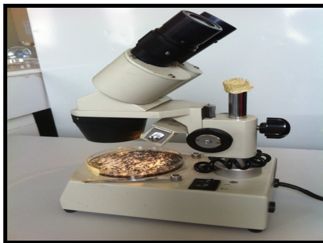
Figure 21 - Dénombrement des pucerons sous la loupe binoculaire (Originale, 2015)
