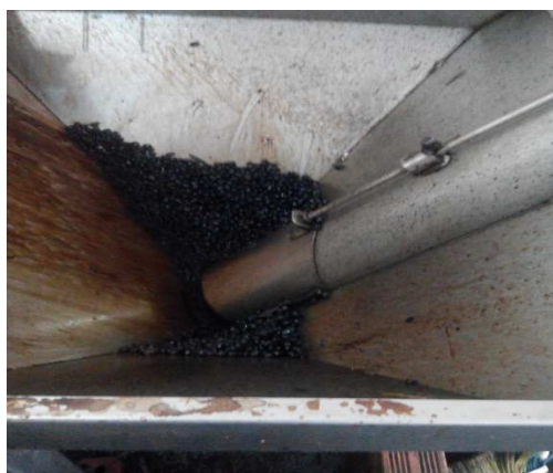
Figure15: Broyage des olives à l'aide d'un broyeur à disk (huilerie moderne de Draa El Mizane) (Originale ,2015).
