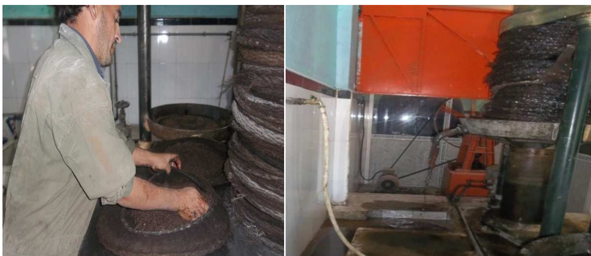
Figure 10: Escourtinage et pressage de la pâte d'olive issue du broyage (Originale, 2015).
