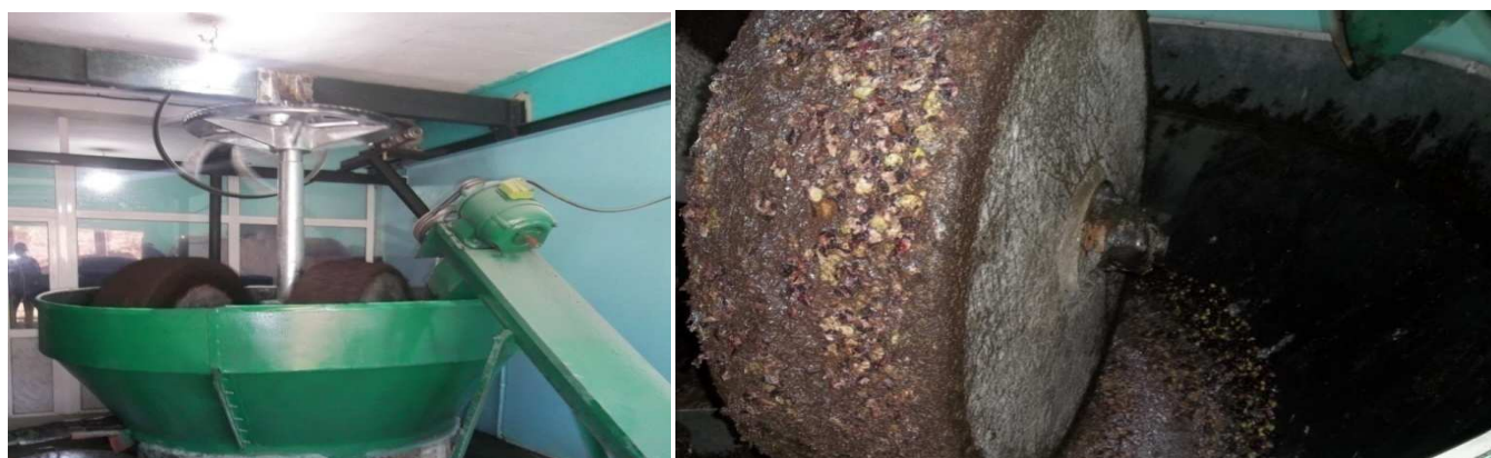
Figure8: Broyage des olives à l'aide du broyeur a meules (huilerie traditionnelle d'Azazga)
