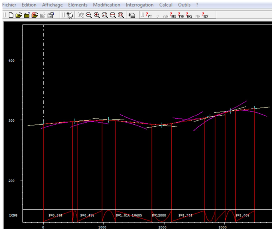
Figure IV. 2 : Eléments du profil en long.
