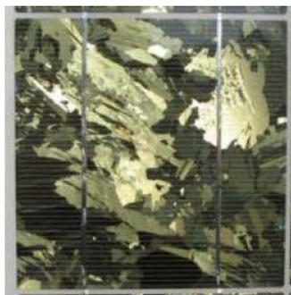
*Figure II. 6: Cellule poly cristallines*
