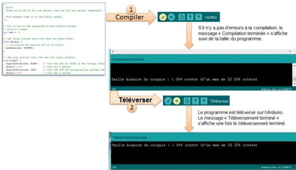
Figure II.18 : Compilation et téléversement d'un programme Arduino.
