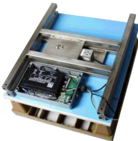
**Figure I.4 :** La ruche connectée CAPAZ GSM200.
