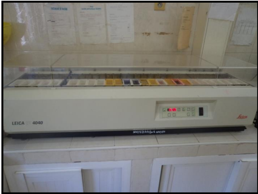
Photographie de la batterie de coloration H.E (laboratoire d'anatomie-pathologie du CHU de Tizi-Ouzou).
