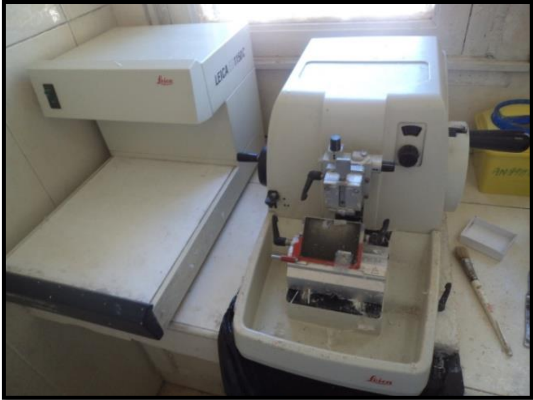
Photographie du microtome (laboratoire d'anatomie-pathologie du CHU de Tizi-Ouzou).
