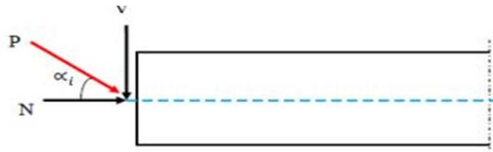
FIGURE VI. 5 : COMPOSANTES DE LA FORCE DE PRECONTRAINTE
