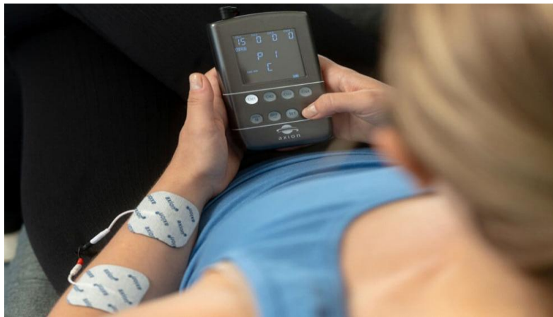
Figure I.4. Un Appareil TENS EMS 4 canaux STIM-PRO X9B avec batterie rechargeable et étui souple [12].
