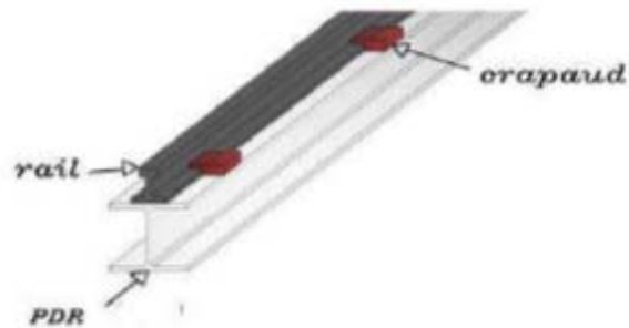
Figure IV.4 : Poutre déroulement avec un rail
