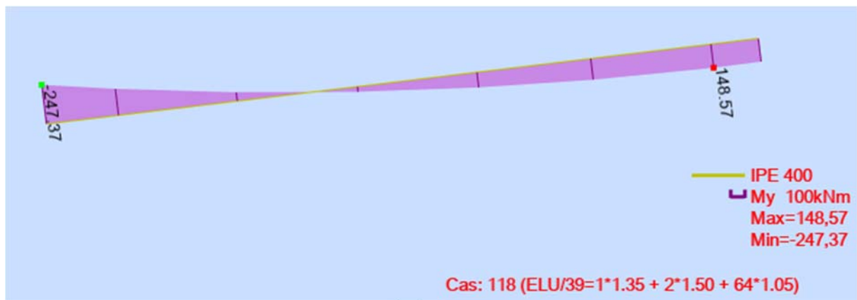
Figure VI.3 Diagramme des moments fléchissant sollicitant sous COMB118 My.sd (kN.m)]
