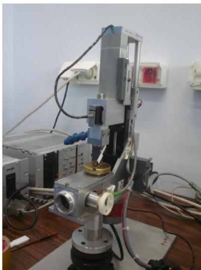
*Figure III-3 : Pégosimètre (Cet appareil a été réalisé au Centre de Recherche Paul Pascal à Bordeaux)*
