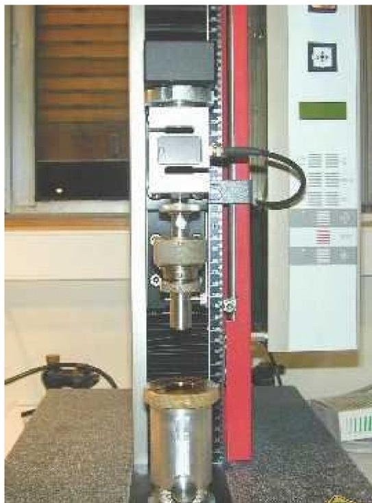
Figure III-1 : machine de traction
