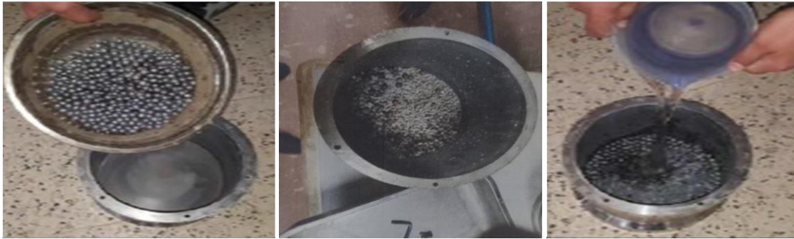
Figure V.2 : Mode opératoire de l'essai micro Deval.
