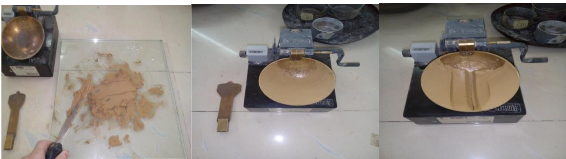
Figure III.7 : Détermination de la limite de liquidité WL.
