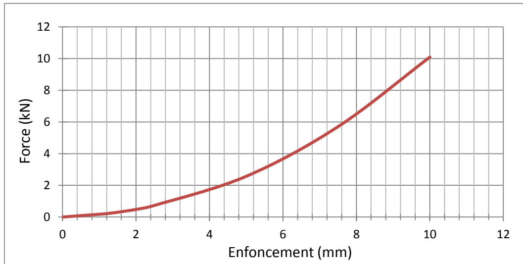
Figure IV.18 : Courbes enfoncements-forces de l'essai CBR après immersion
