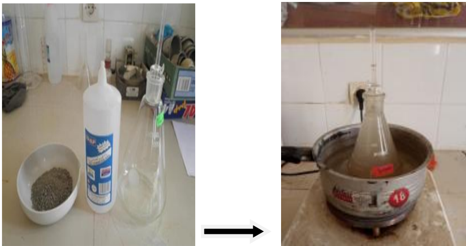
Figure III.6 : mode opératoire de l'essai au pycnomètre.
