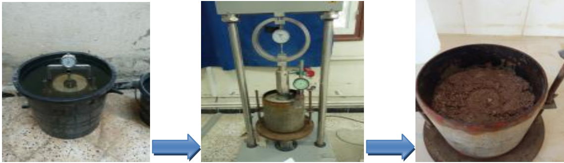
Figure IV.16 : Exécution de l'essai CBR après immersion.
