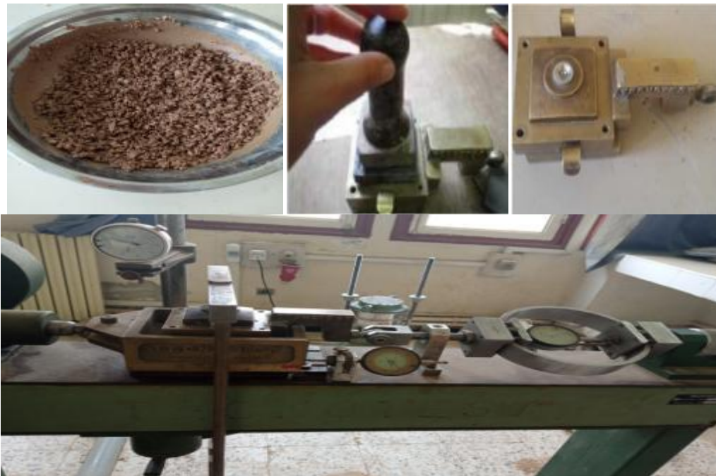
Figure VI.8 : Mode opératoire de l'essai de cisaillement à la boîte.
