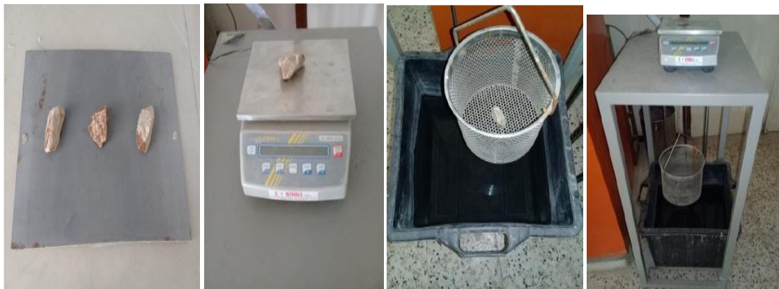
Figure III.5 : Etape de la pesée hydrostatique
