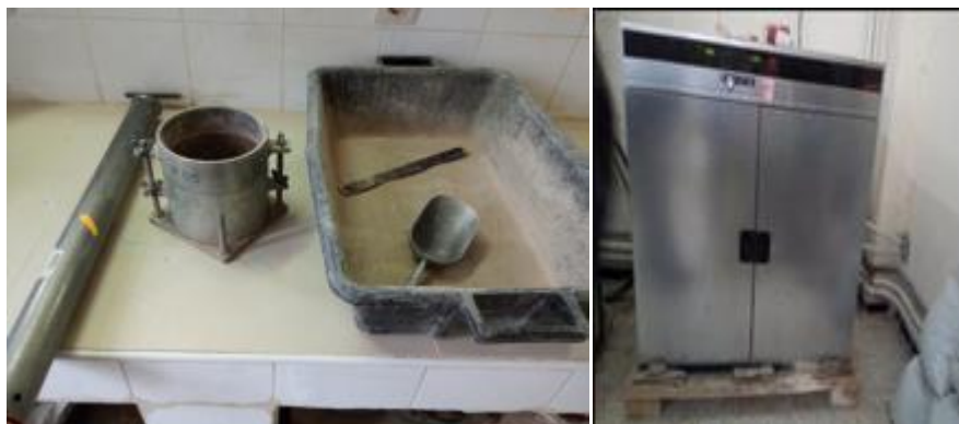
Figure IV.5 : Matériels utilisés pour l'essai Proctor.
