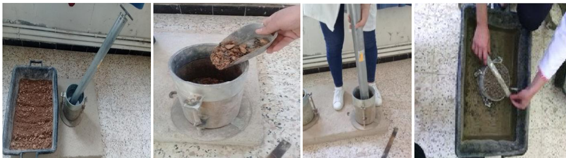
Figure IV.6 : Exécution de l'essai Proctor.
