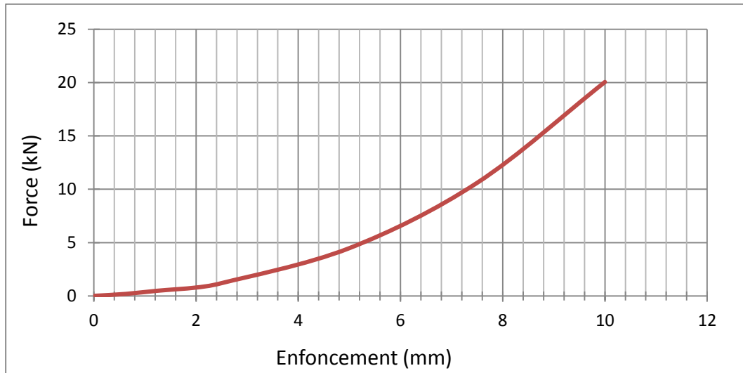
Figure IV.20 : Courbes enfoncements-forces de l'essai CBR après immersion
