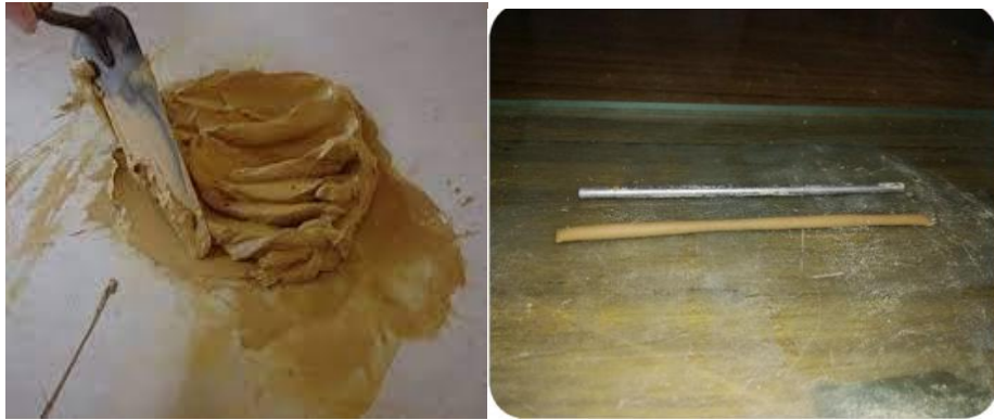
Figure III.8 : Détermination de la limite de liquidité W_p
