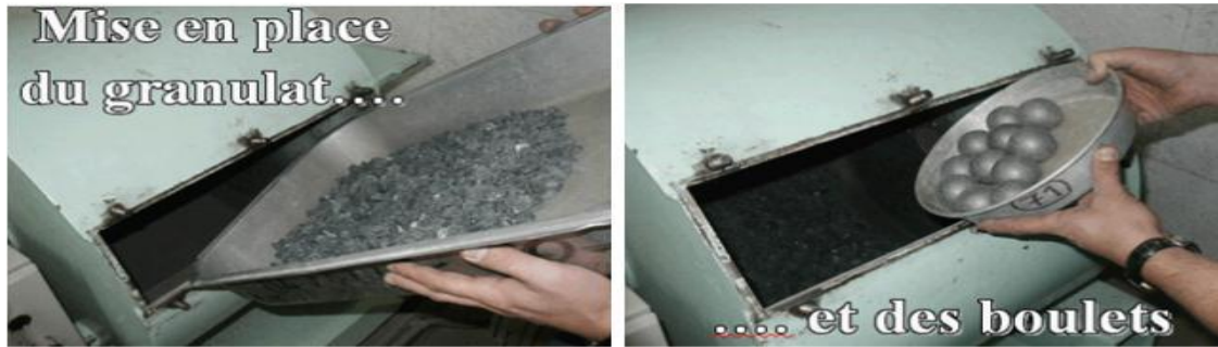
Figure V.5 : Mode opératoire de l'essai Los Angeles.
