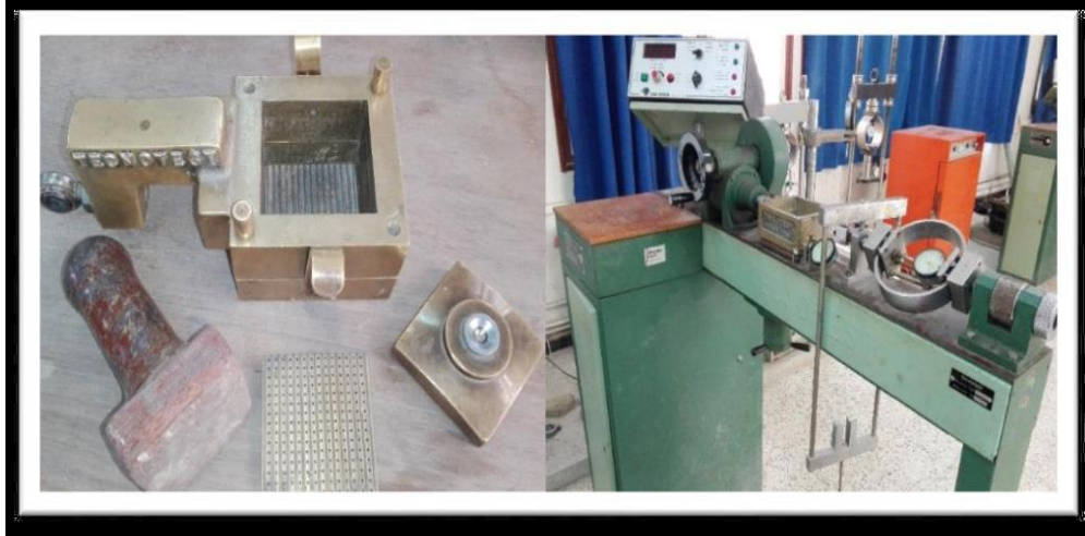
Figure VI.7 : Appareillages de l'essai de cisaillement à la boîte.
