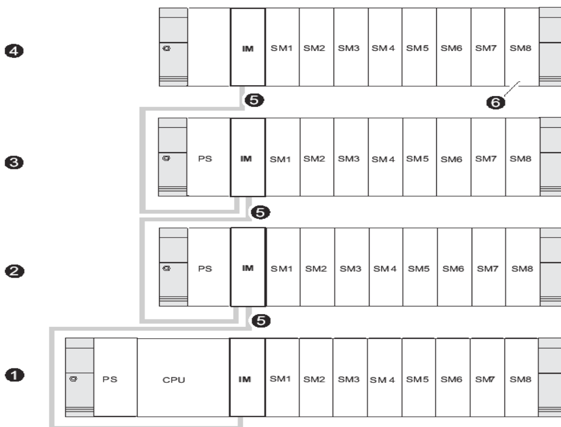
Configuration maximale d'un S7-300 / CPU 314.
