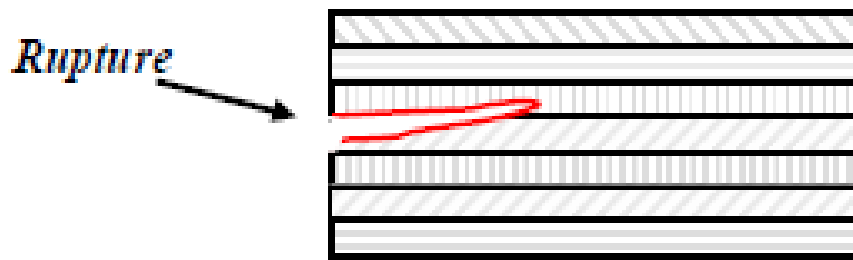
FIGURE II.20 – Rupture de l'interface entre les plis.
