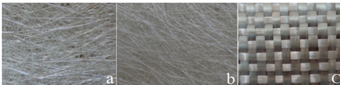
FIGURE III.2 – Les différents renforts utilisés; a) Mat 300\text{g}/\text{m}^2 , b) Mat 450\text{g}/\text{m}^2 , c) Taffetas 800\text{g}/\text{m}^2
