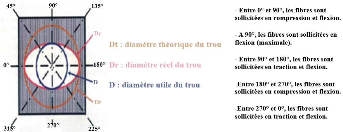
FIGURE II.26 – Sollicitations des fibres selon leur angle par rapport à la vitesse de coupe.
