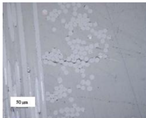
FIGURE II.14 – Observation d'une fissure transverse sur la tranche d'une éprouvette de tissu (sens trame) .
