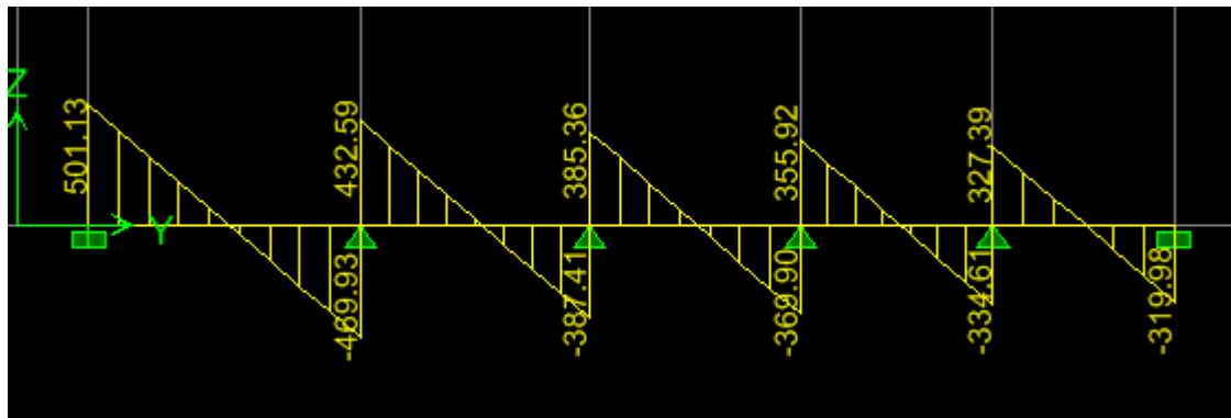
Figure.6: Diagramme des efforts tranchants à l'ELU en KN.m
