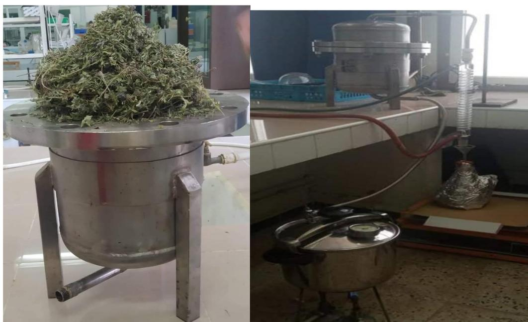
**Figure 07** : Distillateur d'huile essentielle (Photos prises au laboratoire)
