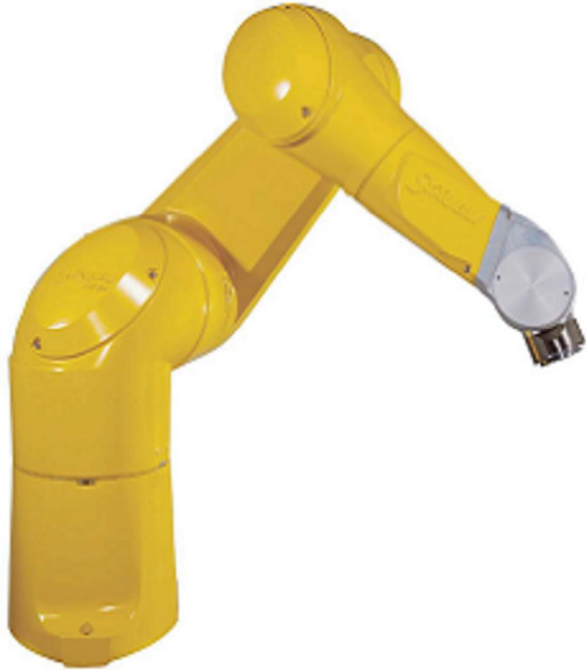
**Figure 1.1 :** Le robot manipulateur Stäubli TX90
