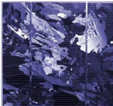
Figure(II.17) : une cellule en silicium multi-cristallin
