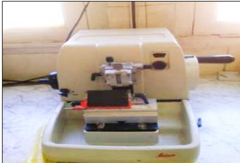
Figure 27 : dispositif de la coupe, microtome (originale, 2022)
