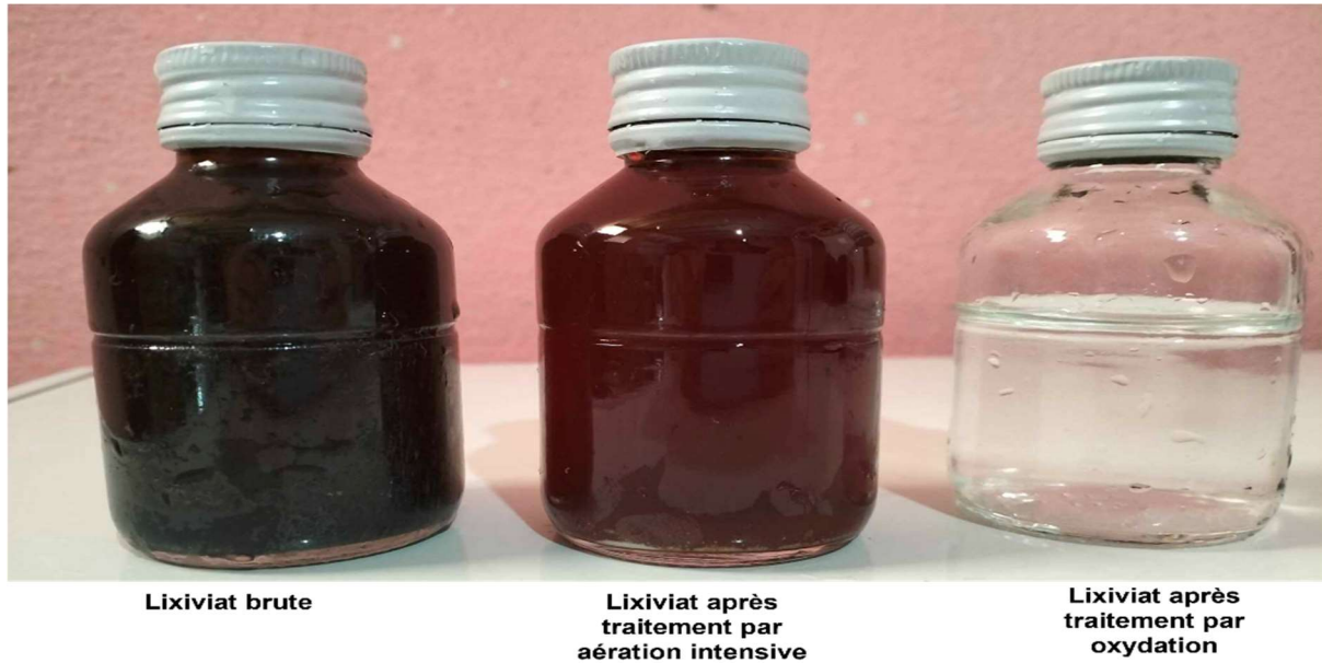
Figure IV.12 : Effet des deux traitements : aération et oxydation sur les lixiviats.
