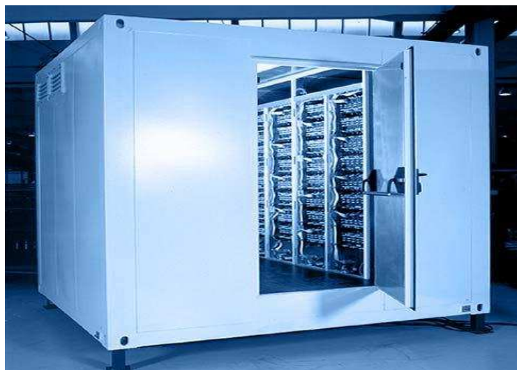
Fig. 3.3 : Pack de supercondensateurs dédié à la récupération de l'énergie lors du freinage [19]
