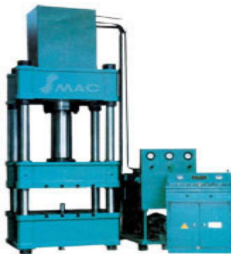
Figure II.4 : presse à simple effet
