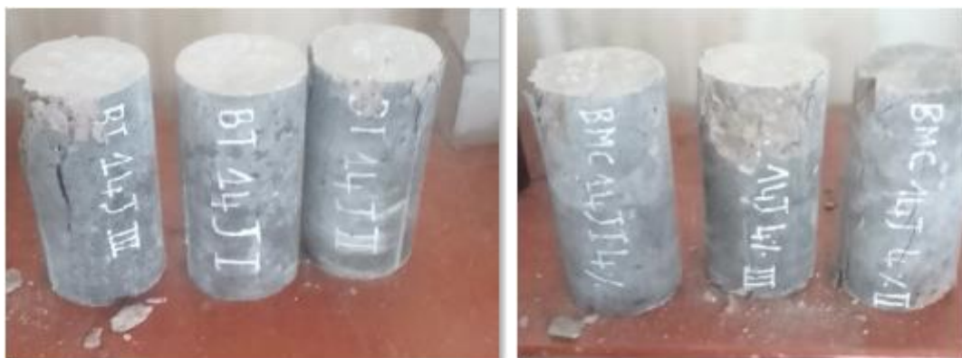
Figure III.8.: Rupture des éprouvettes sous sollicitation de la compression à 14 jours.
