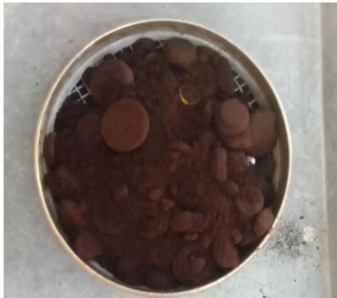
Figure II.3 : Tamisage du marc de café utilisé.
