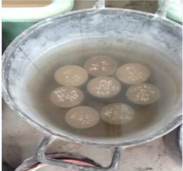
Figure II.15 : Conservation des éprouvettes.
