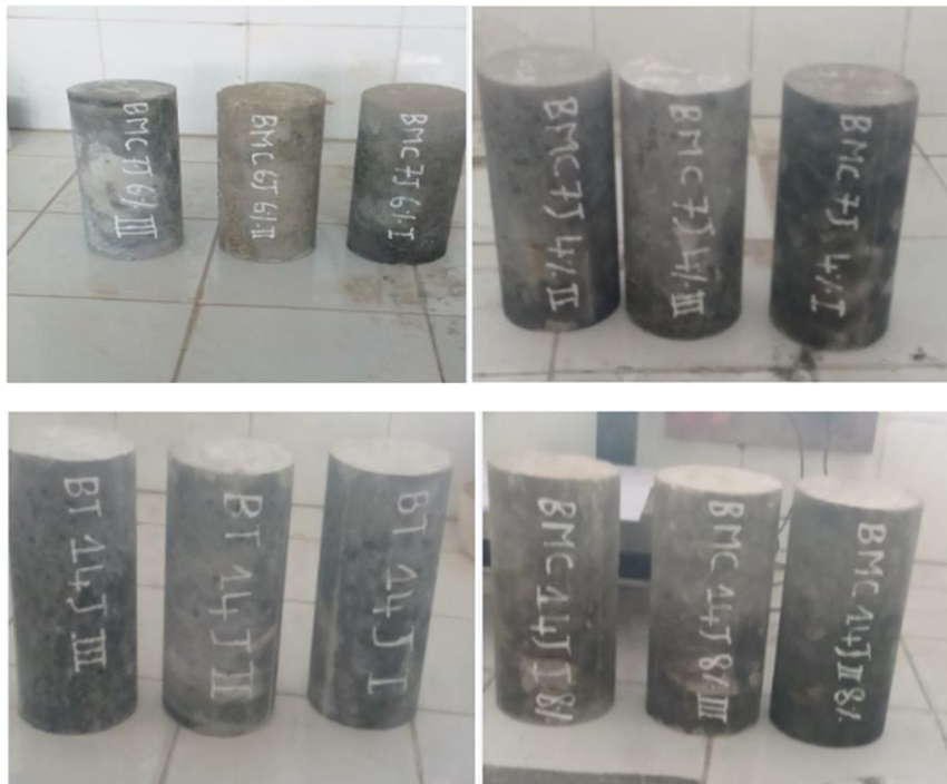
Figure. III.4 : Eprouvtes d'essai de compression
