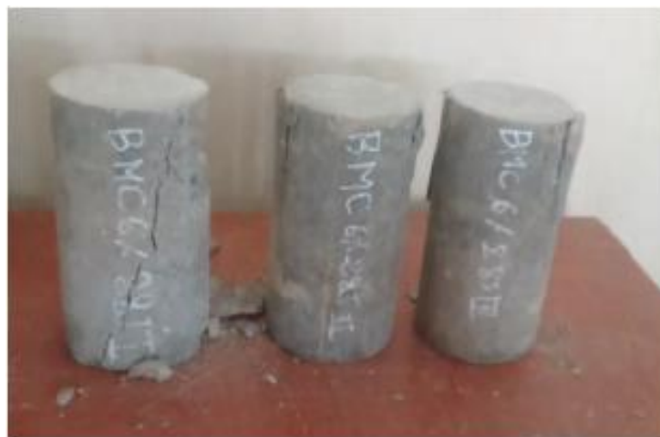
Figure III.10.: Rupture des éprouvettes sous sollicitation de la compression a 28 jours.
