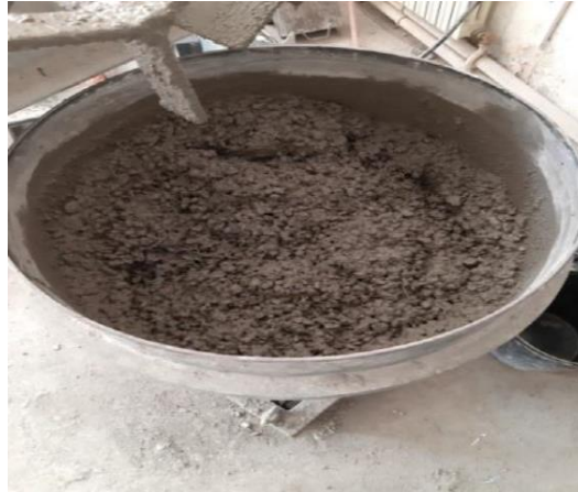
Figure II.11 : Mélange des matériaux après l'ajout de l'eau
