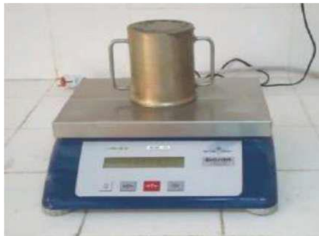
Figure II.16 : Mesure de la densité du béton.
