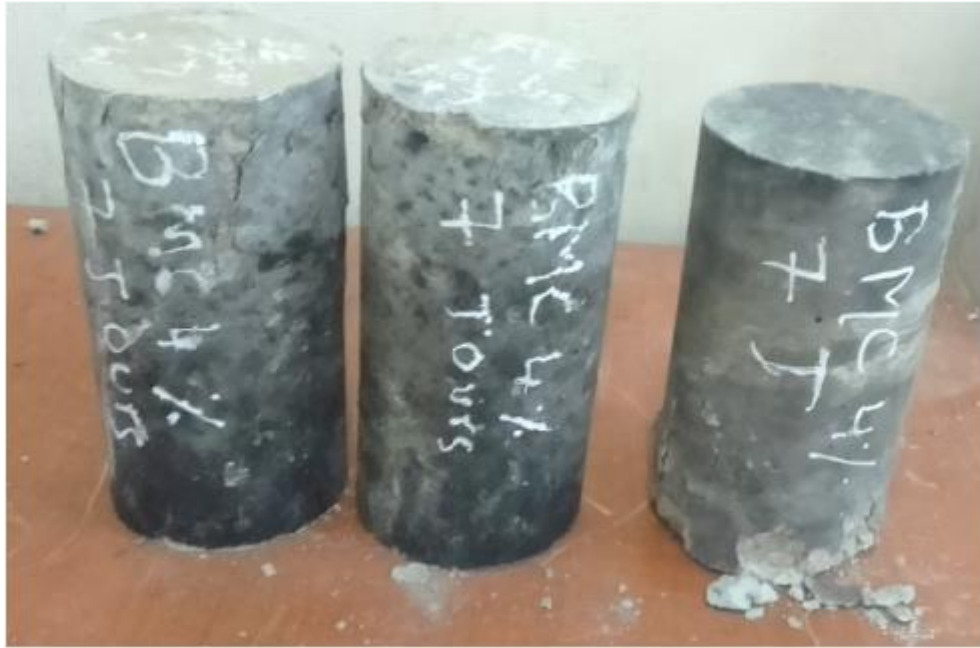
Figure III.6: Rupture des éprouvettes sous sollicitation de la compression a 7 jours
