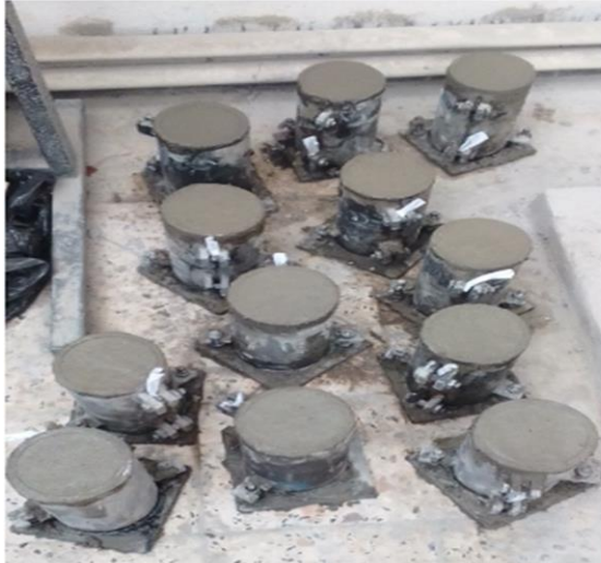
Figure II.14: Remplissage des éprouvettes.
